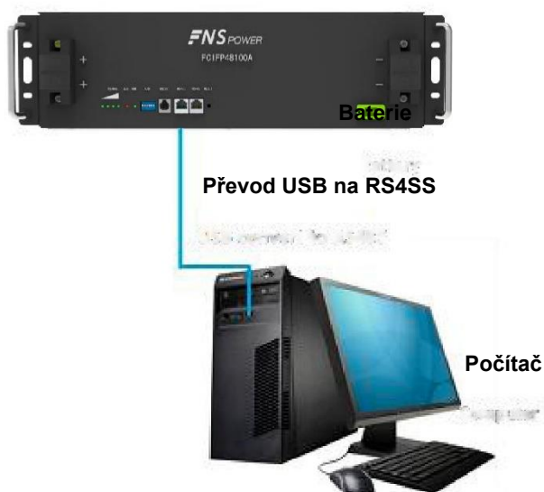
Obrázek 5-3: Připojení komunikačního kabelu mezi baterií a počítačem
